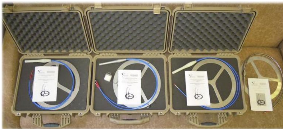
Пробная партия волоконно-оптических зондов с рабочим элементом типа «петля» (для жидких сред) Optokorsa IRF-I
