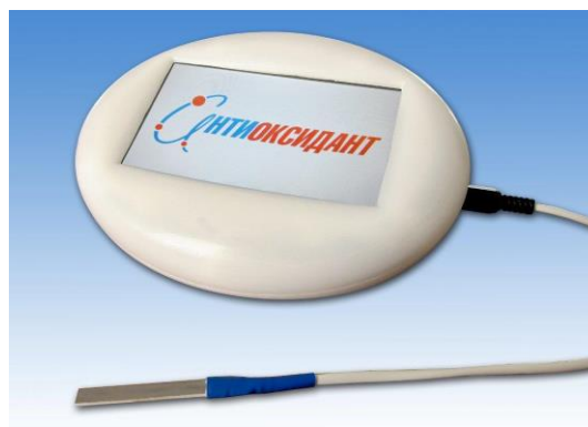
Потенциометрический анализатор определения общей антиоксидантной/оксидантной активности «ПА-S»
