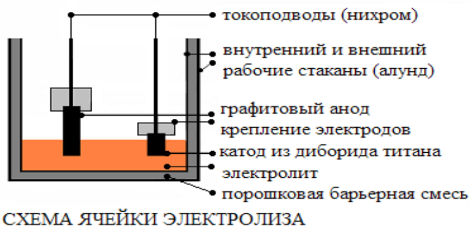
Рис. 3. Схема лабораторной ячейки для электролитического получения алюминия с использованием катода из диборида титана с алюминиевым покрытием.
