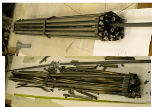
Лабораторный макет ТВС до и после водородного охрупчивания
