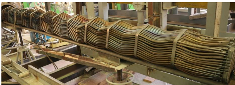
Охрупченный полномасштабный по длине и сечению макет ОТВС
