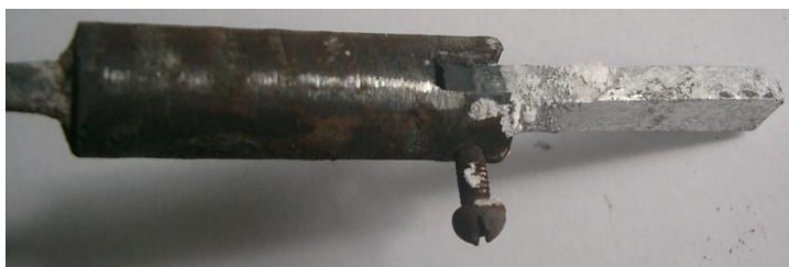
Рис. 2. Электрод TiB_2 с Al покрытием.
