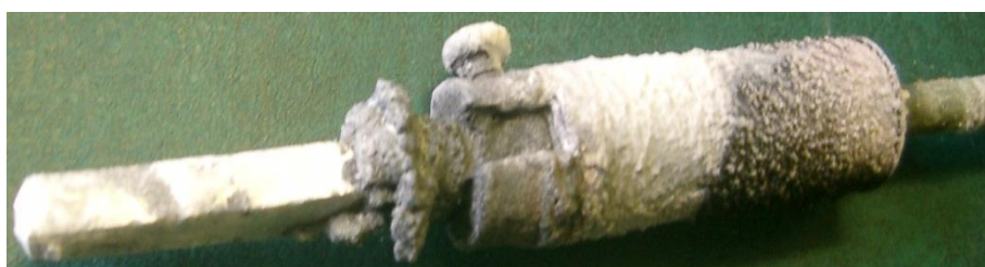
Рис. 4. Катод TiB 2 после электролизных испытаний
