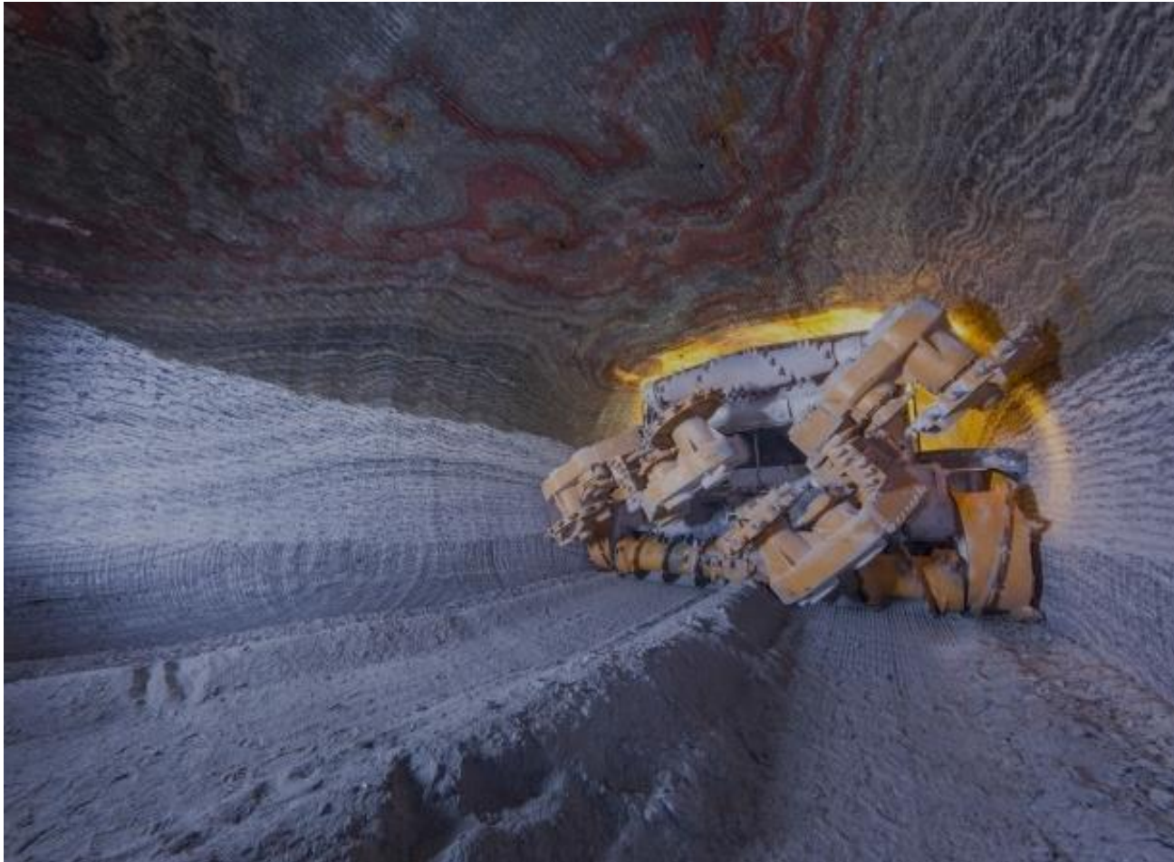
Движение комбайнового комплекса с установленной системой навигации по выработке калийного рудника
