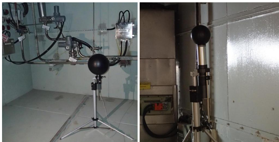
Рис. 41. Размещение спектрометра: рядом с системой труб в помещении, прилегающем к активной зоне реактора ( слева ) и рядом с защитой активной зоны реактора ( справа ).
