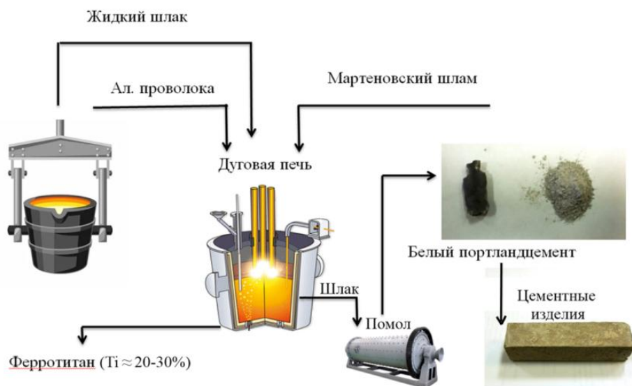
Рис. 61. Технологическая схема получения ферротитана из техногенных отходов металлургического производства.
