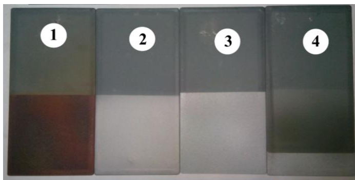
Рис. 54. Многослойные функциональные покрытия. Состав покрытий: подслоя 40% ПТ (порошок термореагирующий – 90% Ni, 10% Al), 30% Al, 30% Zn, и последующие слои (сверху вниз):
