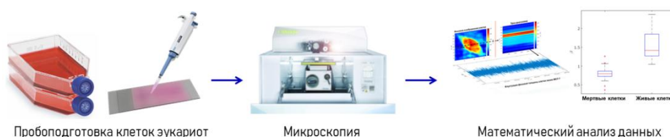
Рис. 70. Способ оценки жизнеспособности клеток эукариот с помощью лазерного интерференционного микроскопа МИМ-340.
