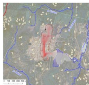
Положение фронта загрязнения, оконтуренного по минерализации более 500 мг/л, в случае сохранения откачки и нейтрализации шахтных вод (на 25 год)
