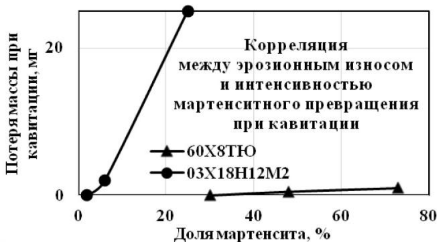
Рис. 21. Корреляция между эрозионным износом и интенсивностью мартенситного превращения при кавитации.
