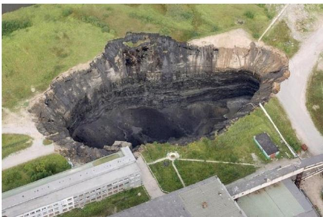
Рис. 134. Последствия катастрофического развития экстремальных ситуаций при затоплении калийных рудников.
