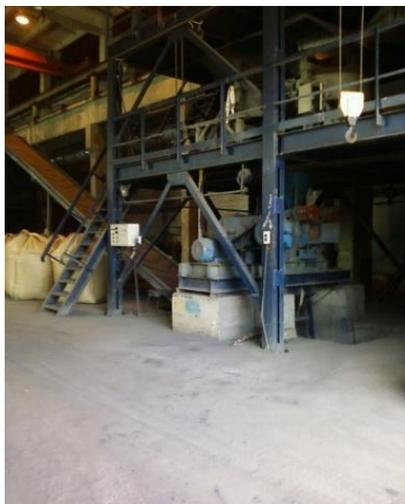
Рис. 67. Брикетный пресс для шихты электроплавки.
