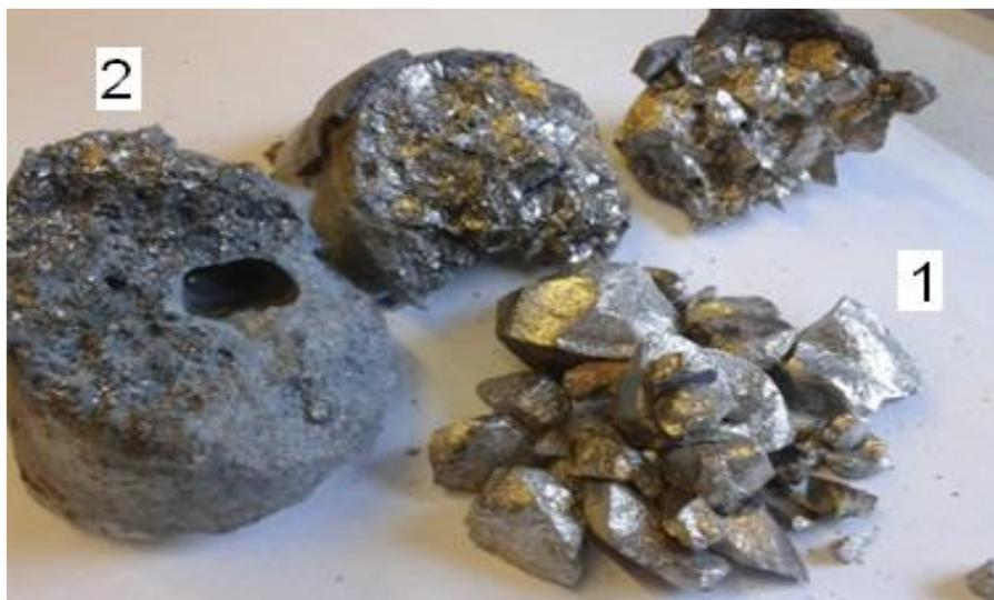
Рис. 69. Продукты алюминотермического получения сплава Al-59 % Zr в индукционной печи: 1 – сплав, 2 – шлак.
