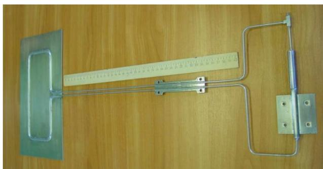
Рис. 33. Миниатюрная контурная тепловая труба.
