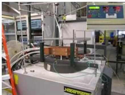
Рис. 71. Электролизер на 1000 А: а) погружение анодов в расплав; б) работа в штатном режиме электролиза с токовой нагрузкой 1000 А.
