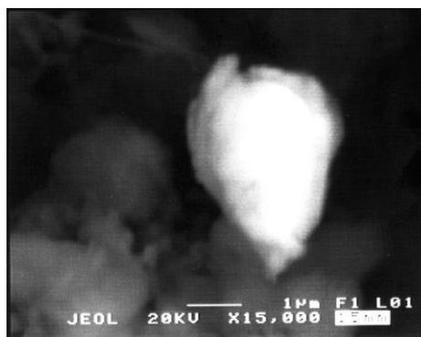
Рис. 128. Отдельная частица, содержащая Fe-Ni фазу.
