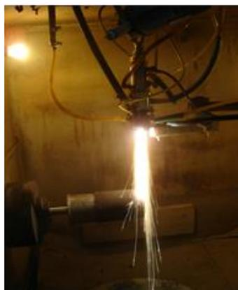
Рис. 59. Установка для сверхзвукового газо-воздушного напыления.
