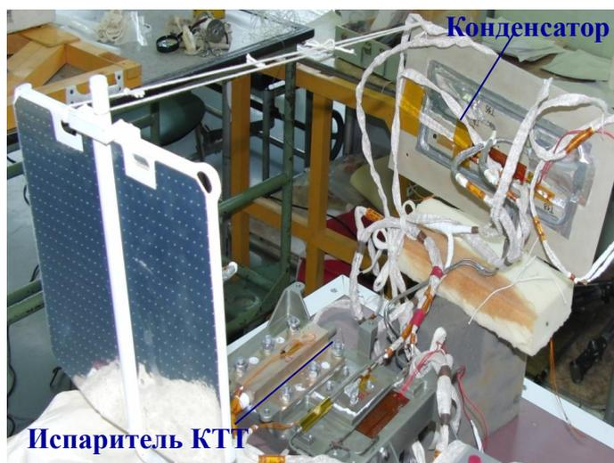
Рис. 34. Система терморегулирования прибора «Дока-Б».
