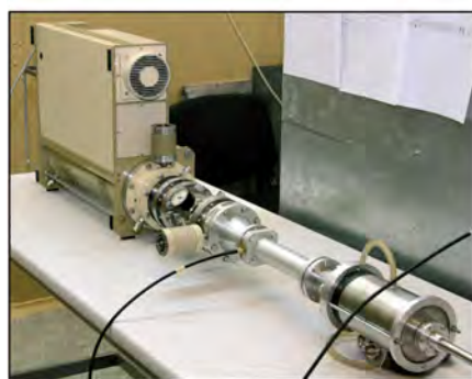
Рис. 17. Экспериментальная установка на основе компактного высоковольтного генератора, геометрия разрядного промежутка и осциллограмма тока пикосекундного иницирующего электронного пучка, сопровождаемого задержанной лавиной вторичных убегающих электронов
