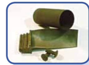
Турбинная лопатка (сплав ЭИ 983), труба (сталь 08Ю), болты (сталь 20). Turbine blade (alloy ЭИ 983), pipe (steel 08Ю), bolts (steel 20).
