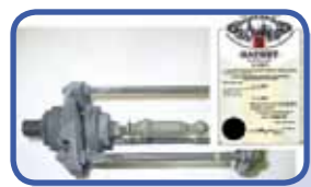
Биметаллический (Ir-Re) корпус ЖРДМТ, электролитически сформированный на графитовой матрице в технологической оснастке. Bimetal (Ir-Re) casing of low-thrust liquid-fuel rocket engine obtained by electroforming on a graphite matrix in a technology fixture.
