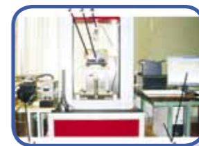
Экспериментальный комплекс для испытаний магнито полимеров: (1) блок питания с выпрямителем (1), электромагнит (2) с зазором для размещения испытуемого образца (3), силоизмеритель (4) и система регистрации (5).
