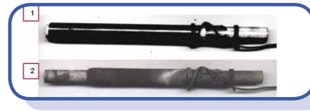
Растворение оболочки циркониевого ТВЭЛа реакторов типа ВВЭР в жидком цинке. Температура ~ 830°C. Время выдержки 15 мин. 1) до опыта; 2) после опыта. Dissolution of zirconium fuel element cans of VVER reactors in liquid zinc at a temperature of ~ 830°C. Exposure is 15 min. 1) before the experiment; 2) after the experiment.
