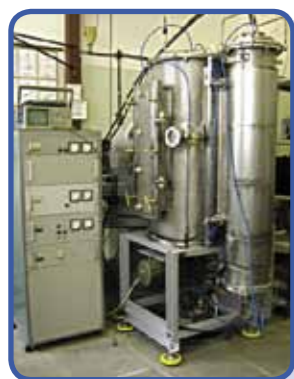
Установка ионно-лучевой обработки. Installation for ion-beam treatment.
