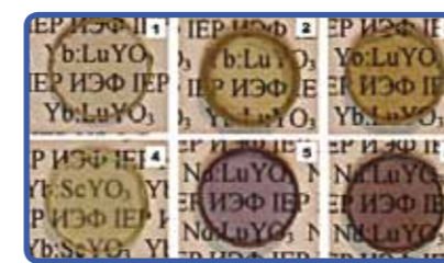
Рис. 1. Фотографии образцов керамик из Yb 3+ :(Lu 0,25 Y 0,75 ) 2 O 3 (1,2,3), Yb 3+ :(Sc 0,25 Y 0,75 ) 2 O 3 (4) и Nd 3+ :(Lu 0,25 Y 0,75 ) 2 O 3 (5,6), допированных 6 мол.% ZrO 2 . Fig. 1. Pictures of ceramic samples of Yb 3+ :(Lu 0,25 Y 0,75 ) 2 O 3 (1,2,3), Yb 3+ :(Sc 0,25 Y 0,75 ) 2 O 3 (4) and Nd 3+ :(Lu 0,25 Y 0,75 ) 2 O 3 (5,6) doped with 6 mol.% ZrO 2 .
