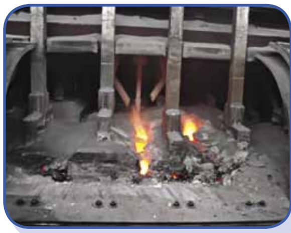
Электролизная ванна для получения алюминия. Electrolysis bath for aluminum making.
