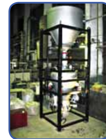
Инжекционная установка НТМ-01 с 4-мя выходами для материала. NTM-01 Injection equipment with four outlets.
