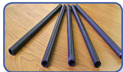
Керамические мембраны для сепарации кислорода. Ceramic membranes for oxygen separation.
