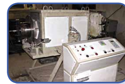
Установка для термодиффузионной обработки металлических деталей. Thermodiffusion aluminizing installation.
