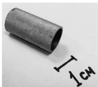
Внешний вид трубки из Ir-Re-Ir композита
