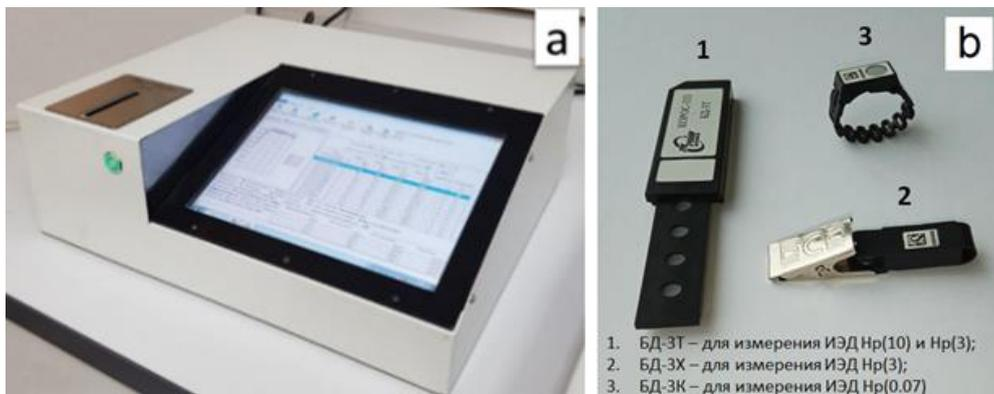
Рис. 19. ОСЛ-считыватель системы КОРОС-333 (а) и три типа дозиметров (б).
