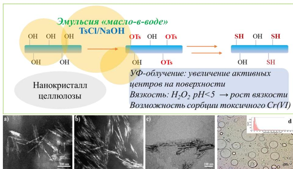
Рис. 57. Микрофотографии синтезированных в эмульсионной среде нанокристаллов целлюлозы (НКЦ) типа «ядро-оболочка», имеющие размеры 150 нм × 7 нм.
