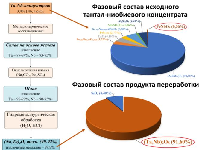
Рис. 92. Технология переработки бедных тантал-ниобиевых концентратов.
