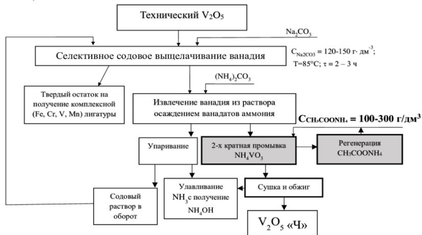
Рис. 93. Принципиальная технологическая схема переработки технического пентоксида ванадия с получением чистого V<sub>2</sub>O<sub>5</sub>. Серым цветом выделен узел промывки ванадатов аммония.
