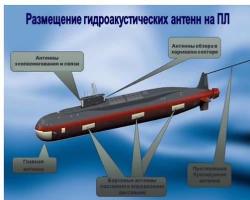
Рис. 73. Виды гидроакустических антенн на подводных судах.
