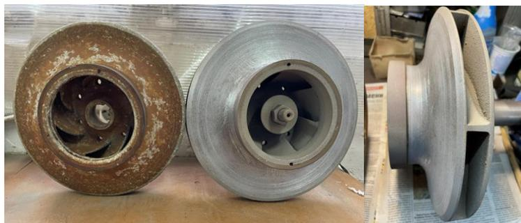
Рис.80. Рабочее колесо пожарного насоса НЦПН-40/100: слева – изношенное колесо, справа – восстановленное методом плазменного напыления.
