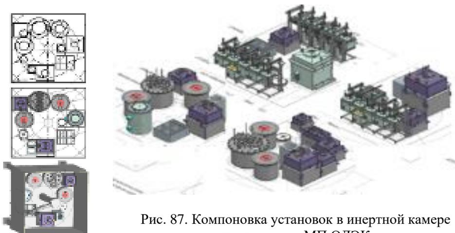
Рис. 87. Компонировка установок в инертной камере пиропередела МП ОДЭК.
