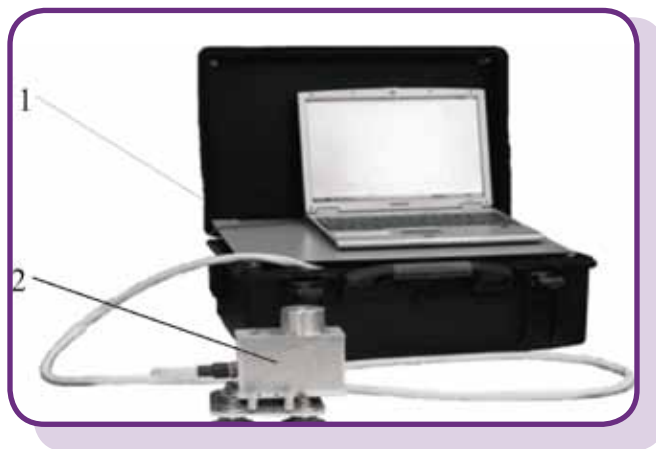
АПК кинетического индентирования усилием до 250 Н. 1 – электронно-вычислительный блок; 2 – зонд-преобразователь, оснащенный пневмозахватами.
