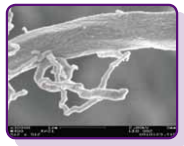
Волокна кремния различного диаметра. Видна боковая огранка толстого волокна, подтверждающая кристаллическую структуру.
