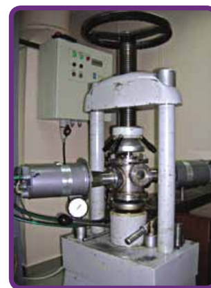
Рис. 2. Статический пресс с УЗ-воздействием на наночастицы.
