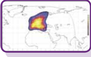
Область покрытия лучом антенны территории Европы, Ku-диапазон (гибридная зеркальная антенна) Total service area of Europe, Ku-band (hybrid reflector antenna)
